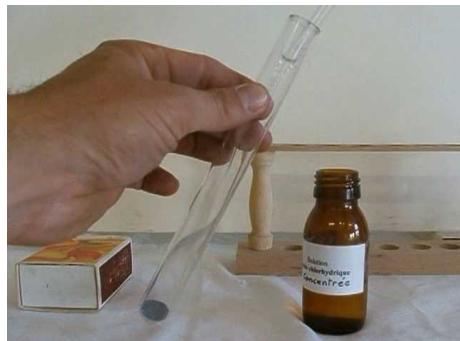
1. Mettre 1/2 spatule de poudre de fer dans un tube à essais puis verser dessus 2 cm<sup>3</sup> d'acide chlorhydrique. Qu'observez-vous ?
