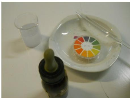
1. Mettre de l'acide chlorhydrique dans un bécher et mesurer son pH à l'aide d'un papier pH :
