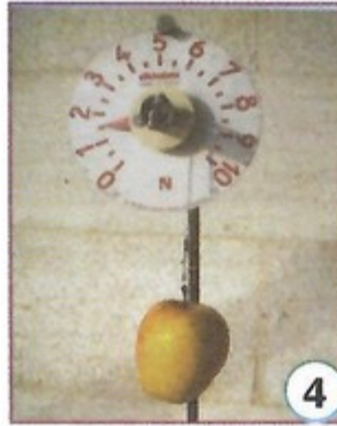
سقوط كرة على الأرض قياس شدة وزن تفاحة بالدينامومتر
