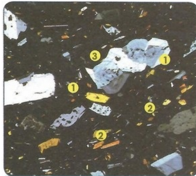
Document 3 : lame mince d'andésite : 1- Gros cristaux ; 2- Petits cristaux (microlites) ; 3 - Pâte vitreuse.
