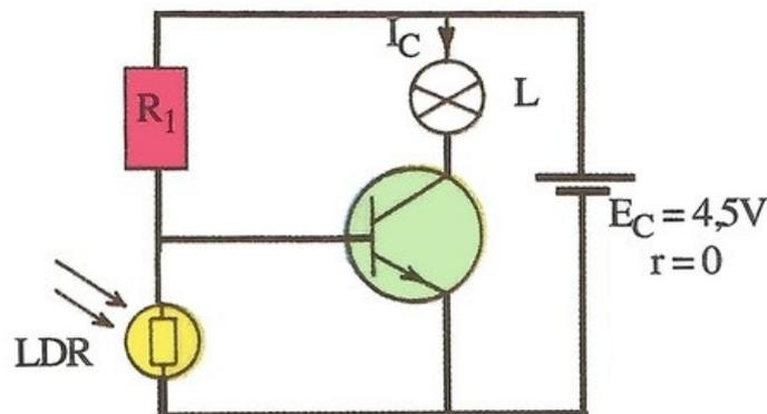
1. Pour quelle valeur de  $R_1$  le transistor est bloqué ? Quand on expose la LDR à la lumière intense ?
