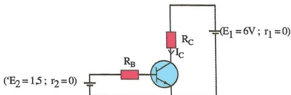
1. Trouver les valeurs des résistances  $R_B$  et  $R_C$  pour que le transistor fonctionne selon les conditions suivantes :
