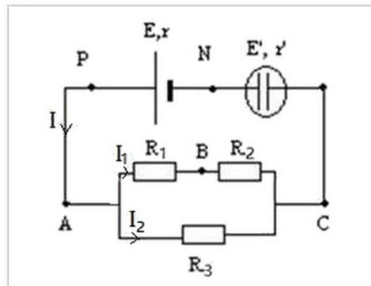
L'électrolyseur à une force contre électromotrice  $E' = 4V$  et une résistance interne  $r' = 5\Omega$ .
