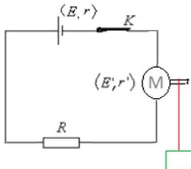
1. Déterminer la puissance  $P_J$  dissipée par effet joule dans l'ensemble (conducteur ohmique+moteur)
