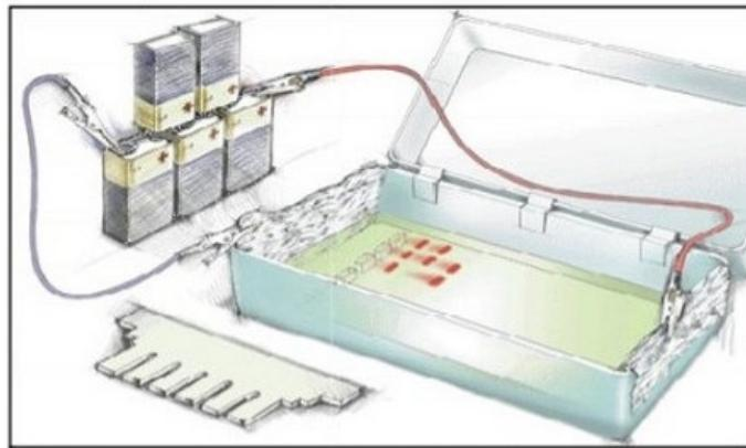
**Figure 1: Dispositif d'électrophorèse**
