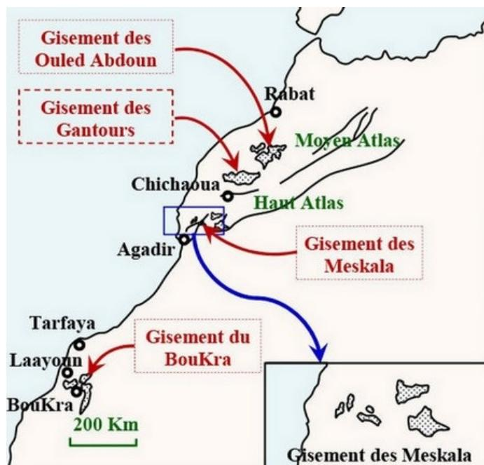
Au Maroc les phosphates se trouvent à une profondeur de 100 à 160 m et sous différentes formes (Sable phosphatés; Silex phosphaté et calcaire phosphaté).
