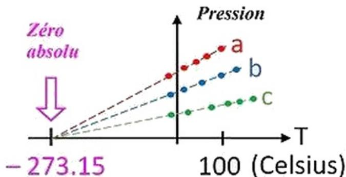
En prolongeant la courbe jusqu'à ce qu'elle se coupe avec l'axe de la température centésimale, on constate que la pression s'annule (théoriquement) lorsque la température est  $-273,15^{\circ}C$ .
