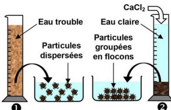
Dans l'éprouvette (1) les molécules argilo-humique restent en suspension dans l'eau.
