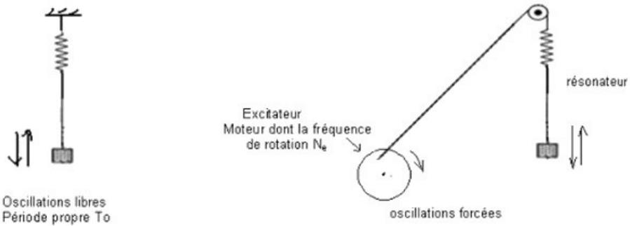
Dans cet exemple le pendule joue le rôle du résonateur, sa fréquence propre est  $N_0$  alors que le moteur joue le rôle de l'exciteur de fréquence  $N_e$ .
