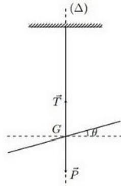
L'action du fil tordu sur la tige est dû à un ensemble de forces auxquelles on associe un couple de forces appelé couple de torsion :  $\mathcal{M}_t = -C \cdot \theta$
