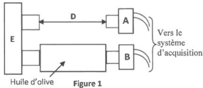
Pour chaque valeur  $D$  de la longueur du tube on mesure, par l'intermédiaire du système informatique, la durée  $\Delta t$  écoulée entre les deux signaux reçus en  $A$  et  $B$ .
