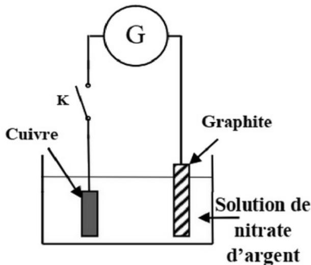
Lors de la fermeture de l'interrupteur  $K$ , le générateur  $G$  délivre au circuit un courant électrique, d'intensité constante  $I = 0,4A$ , pendant une durée  $\Delta t = 70min$ .
