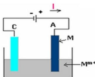
Le bilan de la réaction est nul et cette électrolyse commence à partir de 0V.
