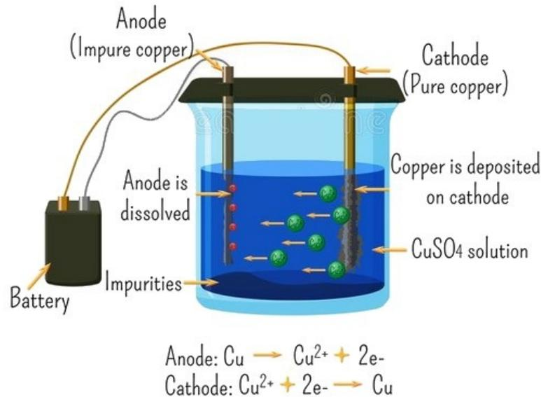
Bilan de l'électrolyse : Transfert du cuivre de l'anode vers la cathode.
