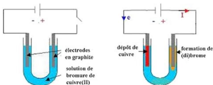
Pendant l'électrolyse, le courant électrique passe de l'anode (pôle positif) vers la cathode (pôle négatif) et les électrons circulent dans le sens contraire.
