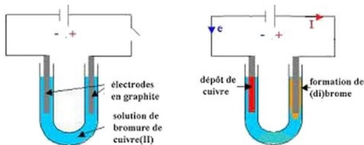
Pour une tension supérieure à 1,2V on constate la formation d'un dépôt de cuivre sur la cathode et formation du dibrome  $Br_2$  au voisinage de l'anode.
