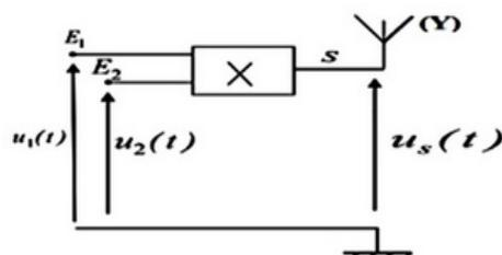
Un générateur  $GBF_1$  applique à l'entrée  $E_1$  de la composante électronique  $X$  une tension sinusoïdale  $u_1(t) = P_m \cdot \cos(2\pi F_P \cdot t)$ , et un générateur  $GBF_2$  applique à l'entrée  $E_2$  de la composante électronique  $X$  une tension sinusoïdale  $u_2(t) = U_0 + s(t)$ , avec  $U_0$  la composante continue de la tension et  $s(t) = S_m \cdot \cos(2\pi f_S \cdot t)$  la tension correspondante à l'onde qu'on désire transmettre.
