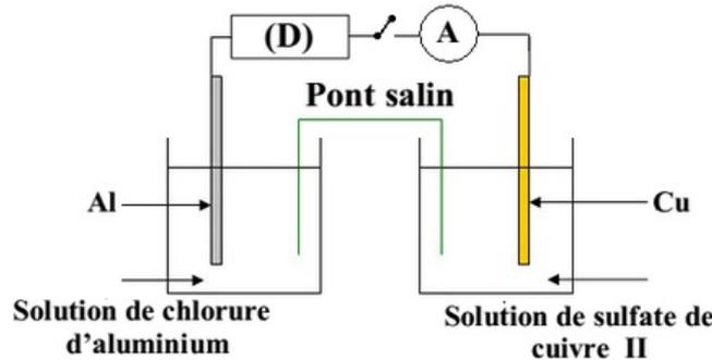
À l’instant  $t = 0$  on ferme le circuit, un courant électrique d’intensité constante  $I$  circule alors dans le circuit.
