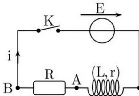
On enregistre à l'aide d'un système d'acquisition informatisé, l'intensité  $i$  du courant qui traverse la bobine lorsqu'on ferme l'interrupteur  $K$ .
