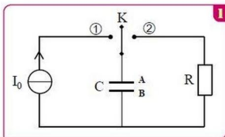
A  $t = 0$  on bascule l'interrupteur à la position 1 et on suit les variations de la tension en fonction du temps et on obtient la courbe de la figure 2 :
