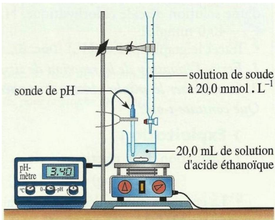
On mesure le pH du mélange après chaque addition et on indique les valeurs obtenues dans le tableau suivant :
