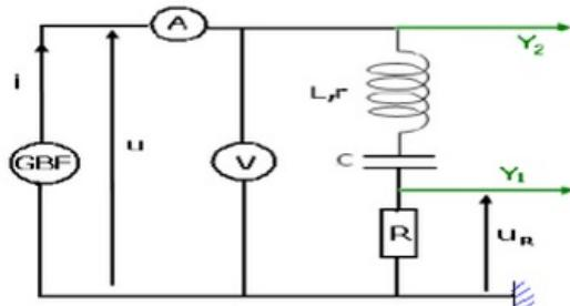
On visualise sur l'écran de l'oscilloscope dans l'entrée  $Y_2$  la tension  $u(t)$  entre les bornes de RLC et dans l'entrée  $Y_1$  la tension  $u_R(t)$  aux bornes du conducteur ohmique.
