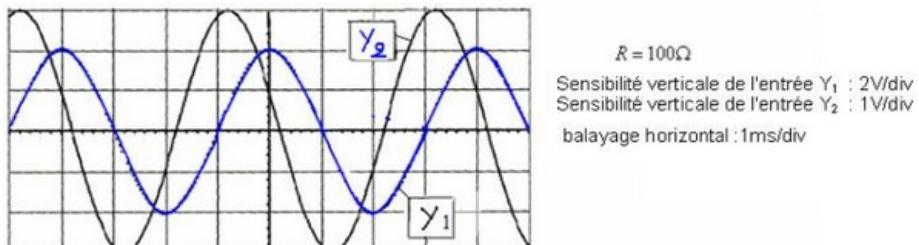
On obtient des oscillations forcées car le générateur GBF impose sur circuit RLC sa fréquence et il l'oblige d'osciller avec cette fréquence, c'est le régime d'oscillations forcées.
