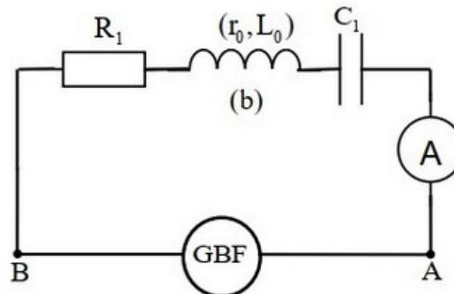
Le coefficient de qualité de ce circuit est  $Q = 7$ , la largeur de la bande passante à  $-3dB$  est  $14,3Hz$ .
