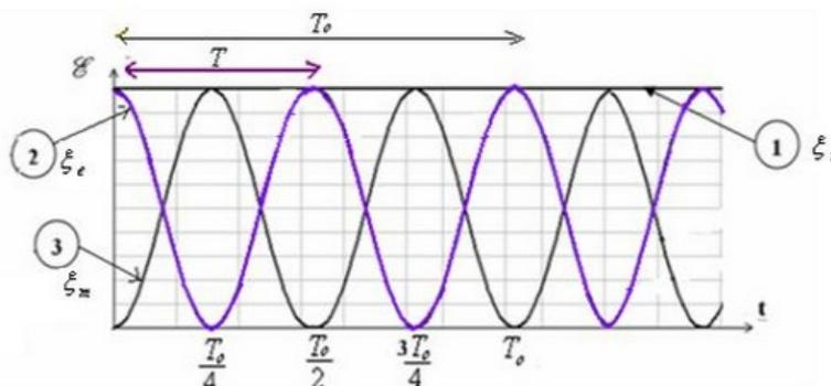
La période  $T$  de l'échange énergétique entre la bobine et le condensateur est égale à la moitié de la période propre  $T_0$ .
