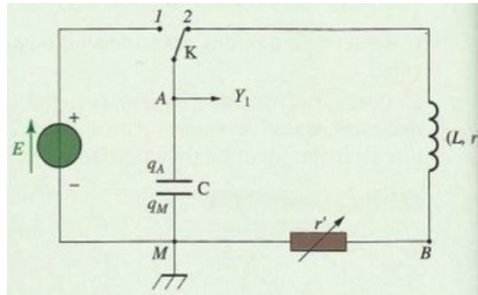
On place l'interrupteur  $K$  à la position (1) une durée suffisante pour que le condensateur soit chargé, puis on le bascule à la position 2 tout en visualisant à la voie  $Y_1$  sur l'écran d'un oscilloscope la tension aux bornes du condensateur.
