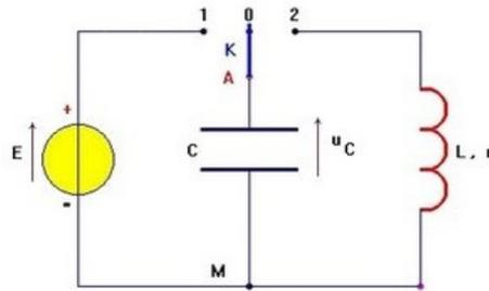
On charge le condensateur de capacité  $C$  à l'aide d'un générateur de force électromotrice  $E$  puis on bascule l'interrupteur  $K$  à la position (2) en prenant cet instant comme origine des temps.
