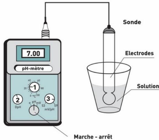
On doit étalonner le pH-mètre avant toute mesure.
