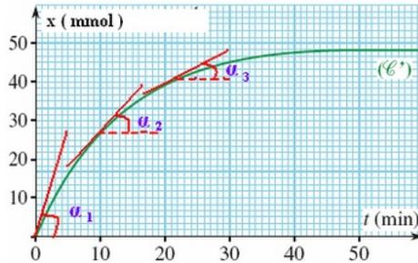
On remarque la diminution de l'angle  $\alpha$  et par conséquent les valeurs de coefficient directeur de la tangente  $\tan(\alpha)$  diminuent au fur et à mesure que la transformation évolue avec le temps.
