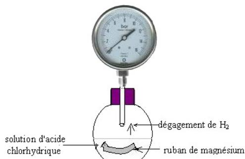
On constate que le magnésium réagit avec l'acide chlorhydrique avec dégagement d'hydrogène et cette réaction dure quelques minutes jusqu'à la disparition totale du ruban de magnésium.
