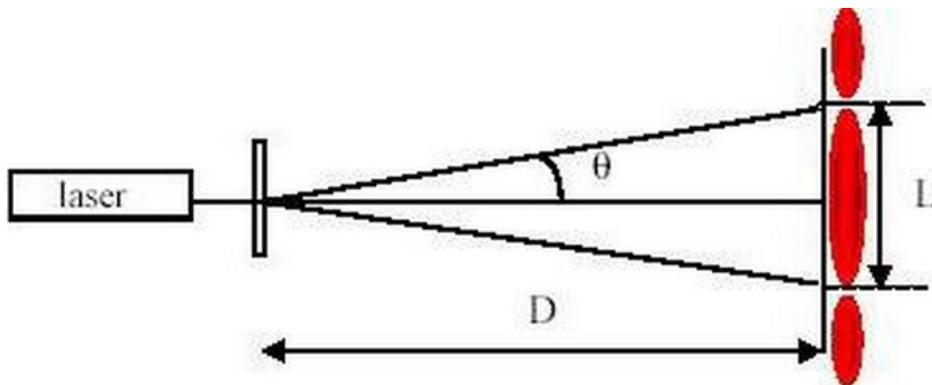
La mesure de la largeur de la frange centrale a donnée la valeur suivante :  $L = 7,6.10^{-2} \text{ m}$
