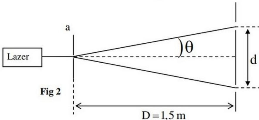
On mesure la largeur  $d$  de la tache centrale pour différentes valeurs de la largeur  $a$  de la fente et on représente graphiquement  $d = f(1/a)$ , on obtient alors la courbe indiquée dans la figure 3 :
