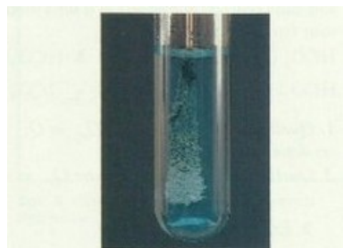
Doc. 3 Réaction entre le cuivre et les ions argent (I). Des aiguilles d'argent apparaissent alors que la solution bleuit progressivement.
