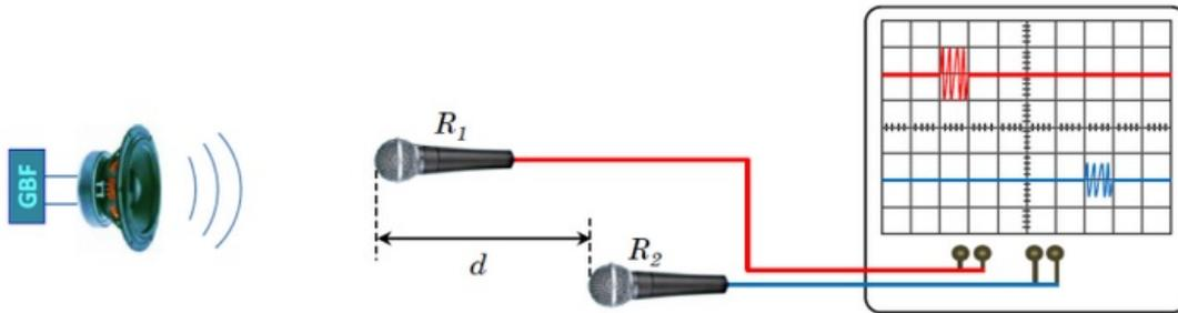
La distance entre les deux microphones  $R_1$  et  $R_2$  est  $d=1,70\text{ m}$ . La courbe ci-dessous représente la variation de la tension aux bornes de chaque microphone.
