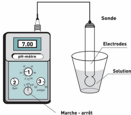
On doit étalonner le pH-mètre avant toute mesure.
