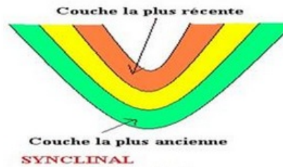
Un pli synclinal Le centre est occupé par les couches les plus récentes.
