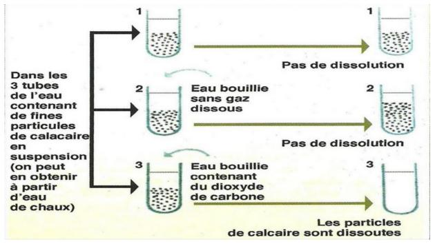
La dissolution du calcaire se fait selon la réaction:
