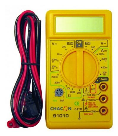
Pour le voltmètre on utilise les bornes (V et COM).
