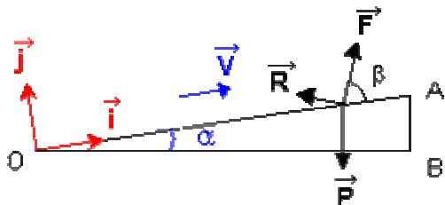
نستعمل محركا لجر جسم (s) ، كتلته  $80\text{kg}$  ، بسرعة ثابتة فوق سطح مائل بزاوية  $\alpha=20^\circ$  ، بواسطة حبل يكون زاوية  $\beta=60^\circ$  مع السطح المائل . عند اشتغال المحرك تكون شدة القوة  $\vec{F}$  المسلطة من طرف الحبل على الجسم  $600\text{N}$  .
