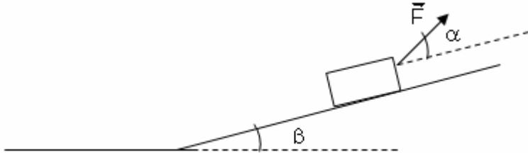
2 - بنقل الجسم من السطح الأفقي إلى سطح مائل بزاوية  $\beta=15^\circ$  بالنسبة للسطح الأفقي . ما هي القدرة الإضافية التي يجب أن يبذلها المحرك كي لا تتغير حركة الجسم مع انحفاظ اتجاه متوجهة القوة ؟ نعطي:  $m=20\text{g}$
