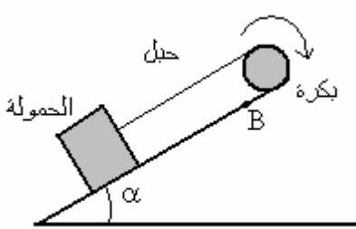
يمكن محرك  $M$  من رفع حمولة كتلتها  $m = 250\text{kg}$  بسرعة ثابتة  $v = 0,5\text{m/s}$  . المحرك عبارة عن أسطوانة ، شعاعها  $R = 10\text{cm}$  ملفوف عليها حبل كتلته مهملة وغير قابل للامتداد . نأخذ  $g = 9,81\text{N/kg}$
