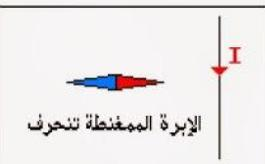
يحدث سلك يمر فيه تيار كهربائي مستمر، مجالاً مغناطيسياً في الحيز المحيط به. ويمكن إبرازه بواسطة إبرة مغناطة، حيث يتعلق انحرافها بمنحني التيار الكهربائي المار في السلك.
