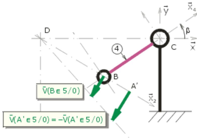
\* Soit A' le point appartenant à  $(D, \vec{x}_2)$  et symétrique du point A par rapport à D. En A' on a :  $\vec{V}(A \in 5/0) = -\vec{V}(A' \in 5/0)$ . Comme D est le CIR de 5/0, à partir du triangle des vitesses de sommet D construit sur  $\vec{V}(A' \in 5/0)$ , on déduit  $\vec{V}(B \in 5/0)$ .
