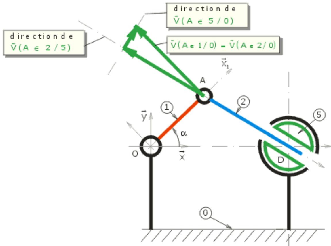
\* O étant le CIR de 1/0, la vitesse en A est suivant  $\vec{y}_1$ . De plus,  $\vec{V}(A \in 1/0) = \vec{V}(A \in 2/0)$
