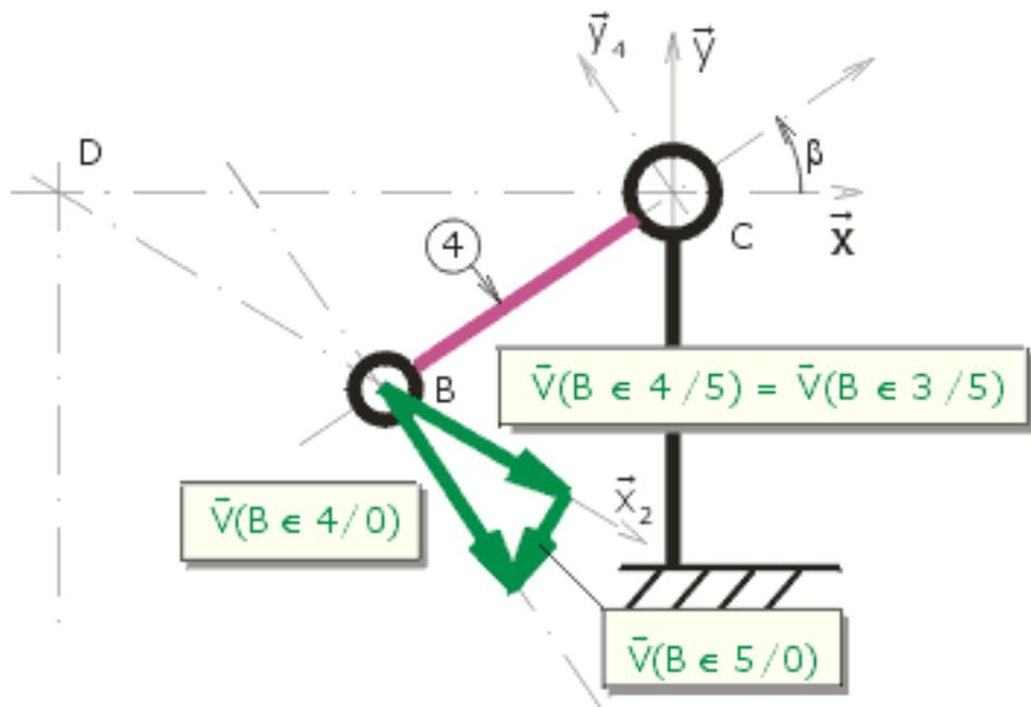
\* Comme C est le CIR de 4/0, la vitesse  $\vec{V}(B \in 4/0) = \vec{V}(B \in 3/0)$  est orientée par  $\vec{y}_4$ .
