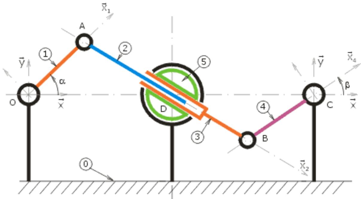
**1** Déterminer graphiquement dans la position particulière de la figure ci-dessus la vitesse de rotation de la pièce (4) par rapport au bâti (0) ( $\vec{\Omega}_{4,0} = \dot{\beta} \cdot \vec{z}$ ) en fonction de la vitesse de rotation du bras (1) par rapport au bâti ( $\vec{\Omega}_{1,0} = \dot{\alpha} \cdot \vec{z}$ ) avec  $\dot{\alpha} = 1500 \text{tr} / \text{mn}$ . On aura soin de démontrer que ce résultat est indépendant de l'échelle de représentation du mécanisme.
