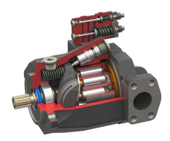
L'arbre moteur entraine en rotation un barillet contenant les pistons, en liaison pivot glissante avec celui-ci. Chaque piston est lié par l'intermédiaire d'une liaison rotule à un plateau mobile parallèle à un plateau fixe qui glissent l'un sur l'autre (liaison appui plan).
