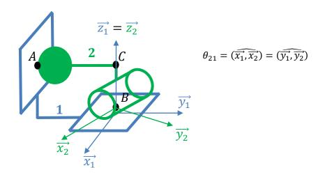
On suppose que le vecteur  $\overrightarrow{AC}$  reste porté par  $\overrightarrow{y_2}$  et que  $\overrightarrow{BC}$  reste porté par  $\overrightarrow{z_1} = \overrightarrow{z_2}$ . Même si les points A ou B venaient à bouger, le point C sera le point vérifiant ces conditions.
