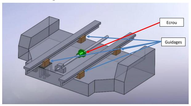
On réalise un guidage en translation par l'intermédiaire de deux rails en parallèle sur lesquels est fixé par encastrement sur les surfaces planes supérieures des rails un plateau non visible sur la vue 3D cidessus. Ce plateau possède, sur sa partie inférieure, une pièce soudée dans laquelle vient s'emboiter la pièce « Ecrou » par l'intermédiaire de deux surfaces et un arrêt par vis. Le mouvement de translation de l'ensemble Plateau-Pièce soudée-Ecrou est ainsi piloté par la vis..
