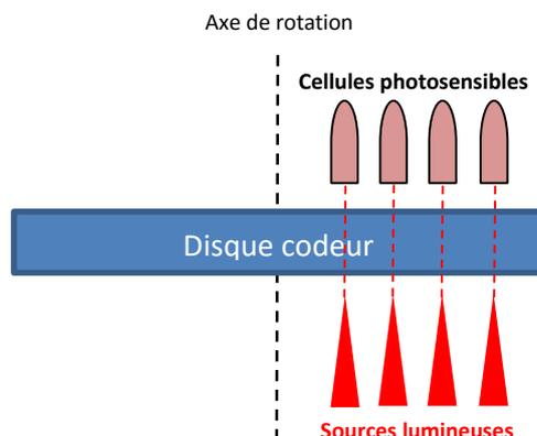
Le disque codeur est donc divisé en 4 pistes de 4 diamètres différents, puis on crée des trous lorsque l'on veut que l'information 1 transite, et on laisse la matière lorsque l'information ne doit pas passer. On peut par exemple prendre un disque en matériau transparent et coller un film opaque sur lequel on va graver (cases noires) les lieux où la lumière doit passer.
