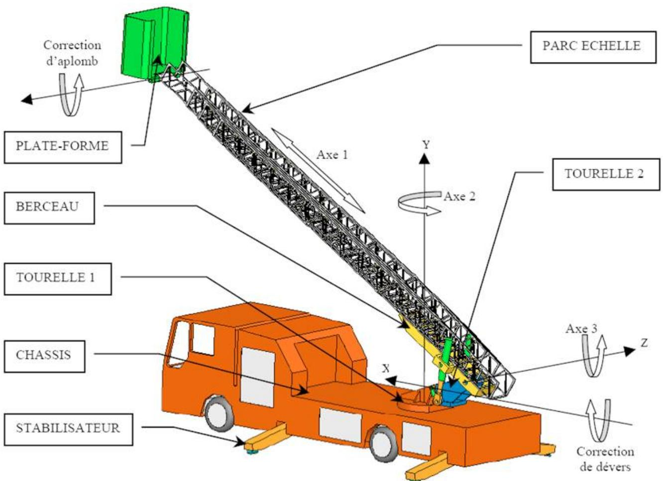
Le déplacement de la plate-forme est réalisé suivant trois axes :
