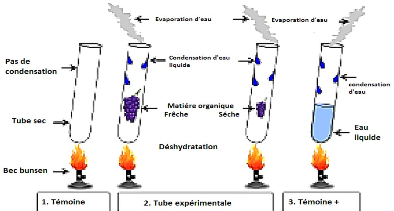
Les aliments ainsi que les êtres vivants contiennent de l'eau à l'état liquide. Cette eau est vaporisée par le chauffage puis se condense lors de son refroidissement au contact avec la paroi froide du tube. C'est une mise en évidence qualitative pas quantitative.
