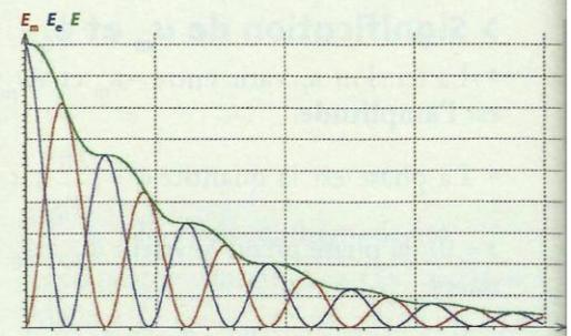
Doc. 10 Évolution, au cours du temps, des énergies électrique  $E_e$  (courbe bleue) et magnétique  $E_m$  (courbe rouge), ainsi que l'énergie totale  $E$  (courbe verte) dans un circuit (R, L, C) série.
