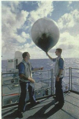
En montant, le ballon grossit, car la pression atmosphérique diminue. Sa paroi élastique finit par éclater à une altitude généralement comprise entre 20 et 30 kilomètres. Après l'éclatement, un petit parachute s'ouvre pour ramener la nacelle et son matériel scientifique au sol. Il faut ensuite localiser la nacelle, puis
