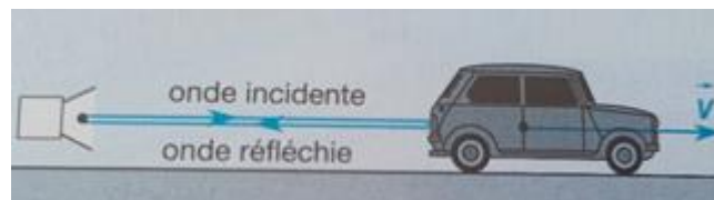
Figure 4. Schéma de principe de fonctionnement d'un radar
