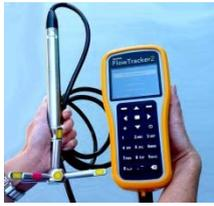
Il est possible d'utiliser un courantomètre acoustique à effet Doppler. Ce dispositif émet des ondes ultrasonores de fréquence  $f_e$  égale à 500 kHz se propageant dans l'eau de mer à la vitesse  $c$  égale à 1500 m.s<sup>-1</sup>. Ces ondes ultrasonores sont réfléchies par les particules en suspension dans l'eau qui se déplacent avec le courant à la vitesse  $v$ .
