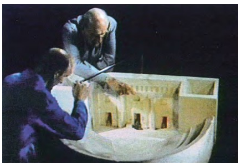
Étude acoustique du théâtre d'Orange à l'aide d'une maquette.
