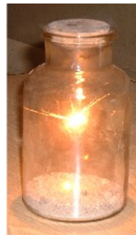
FIG. 7 – Combustion du fer dans le dioxygène.
