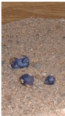
FIG. 8 – Particules d'oxyde de fer au fond du flacon.
