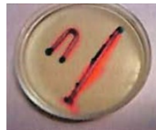
FIG. 4 – Clou écroui. Mise en évidence des contraintes. Solution saline et agar-agar.
