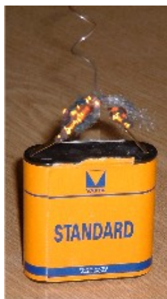
FIG. 6 – Court-circuit avec une pile et de la laine de fer.
