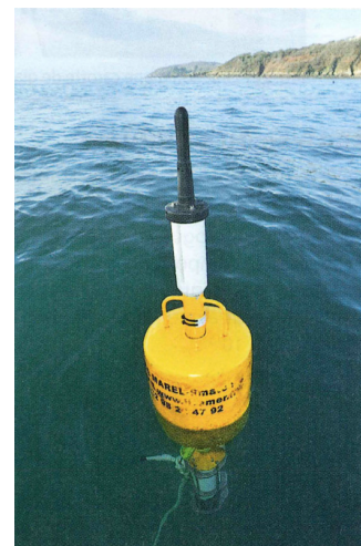
Bouée de mesure de la conductivité en continu.
