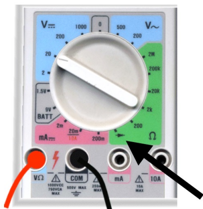
FIG. 7 – Test d'une diode. Bien noter le branchement des fils et la position du commutateur.
