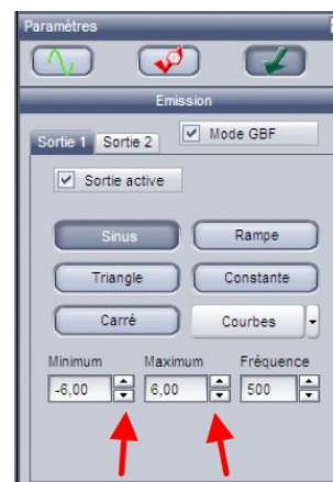
FIG. 20 – Réglage de l'amplitude du GBF
