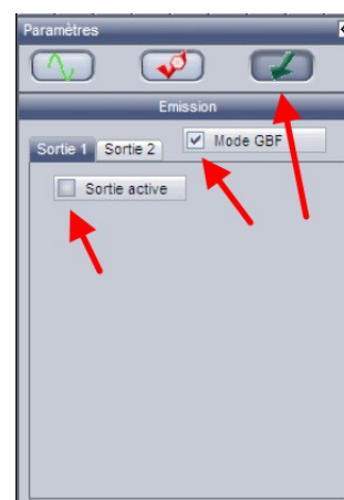
FIG. 12 – Activation des sorties sous Latis Pro.
