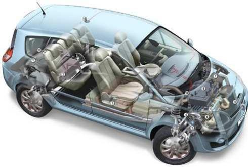
FIG. 2 – Un véhicule utilisant une pile à combustible.
