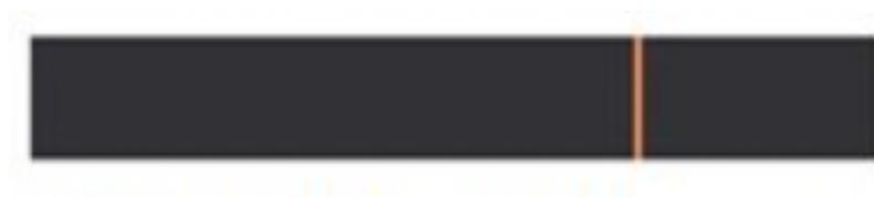
Une radiation lumineuse est dite polychromatique lorsqu'elle est composée de plusieurs radiations de longueurs d'onde différentes (donc de plusieurs couleurs). Exemple : le spectre d'émission du sodium (Na).
