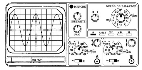
**2.** On veut maintenant mesurer la célérité du son dans l'air en émettant des salves d'ultrasons de fréquence  $f_2 = 40~000~Hz$ , et en mesurant le retard  $\tau$  de l'arrivée d'une salve à un récepteur 2 par rapport à un récepteur 1, et la distance d séparant les 2 récepteurs (voir figures ci-dessous).
