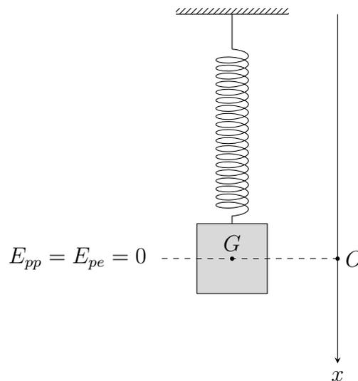
**Énergie potentielle :** On considère que lorsque le système est en équilibre  $E_{pe} = 0$ , ainsi que le plan passant par  $G$  à l'équilibre, constitue l'état référentiel de l'énergie potentielle de pesanteur  $E_{pp} = 0$  :
