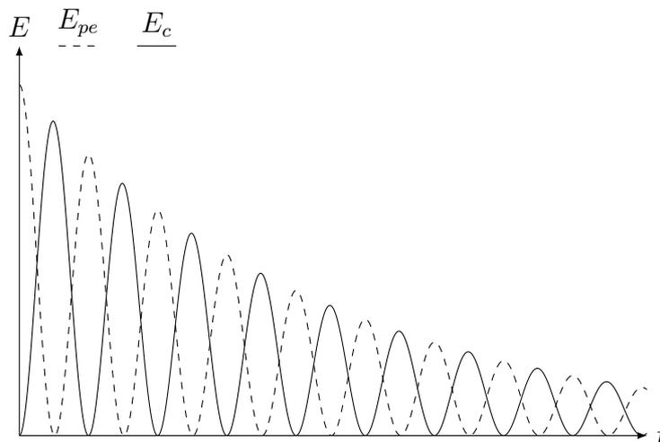
L'énergie mécanique se transforme progressivement en chaleur, et le mouvement continue jusqu'à que le système revienne à sa position d'équilibre. Sa dérivée est donc négative vaut le travail des forces de frottements.
