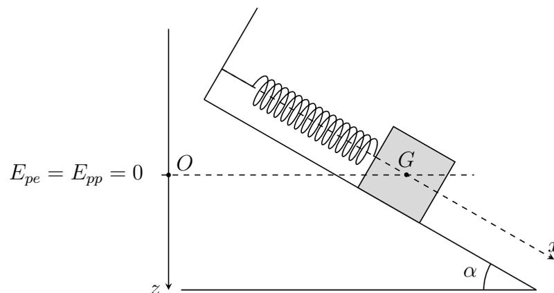
**Énergie potentielle :** On considère que l'énergie potentielle élastique est nulle  $E_{pe} = 0$  lorsque le système est en équilibre, ainsi que le plan passant par  $G$  constitue à l'équilibre l'état référentiel de l'énergie potentielle de pesanteur  $E_{pp} = 0$  : On sait que :
