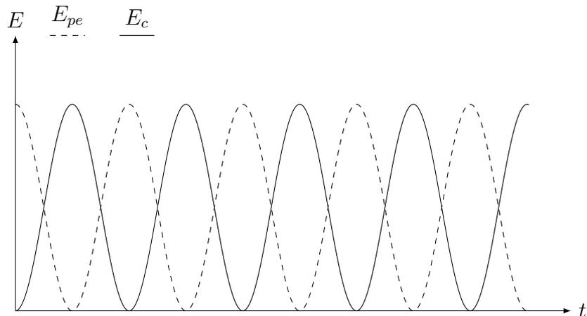
On constate un échange d'énergie potentielle et cinétique dans le système.
