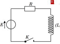
On ouvre à l'instant t = 0 l'interrupteur K puis on visualise la tension aux bornes de conducteur ohmique en fonction de temps  $u_R = f(t)$  (voir la figure 2):
