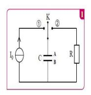
Partie 1- A t=0 on bascule l'interrupteur à la position 1 et on suit les variations de la tension  $u_C$  en fonction du temps et on obtient la courbe de **la figure 2**.
