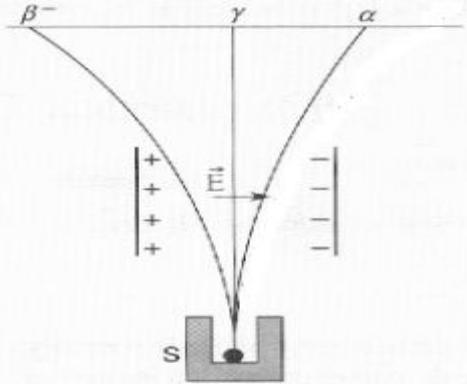
Il existe trois types de rayonnements naturels issus de la matière radioactive: les rayons  $\alpha$  , les rayons  $\beta^-$  et les rayons  $\gamma$  .
