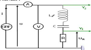
On visualise sur l'écran de l'oscilloscope dans l'entrée  $Y_2$  la tension u(t) entre les bornes de RLC et dans l'entrée  $Y_1$  la tension  $u_R(t)$  aux bornes du conducteur ohmique .On obtient l'oscillogramme de la figure suivante:
